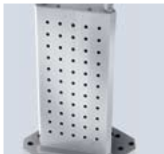
Standard-Bohrungsraster feinstgefräst, mit durchgehendem Bohrungsraster 50 mm
